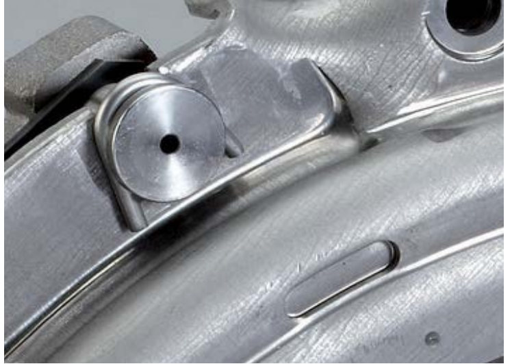
Resim 2: Kilitleme pimleri, stop pimleri ve debriyaj muhafazası arasında monte edilir.
