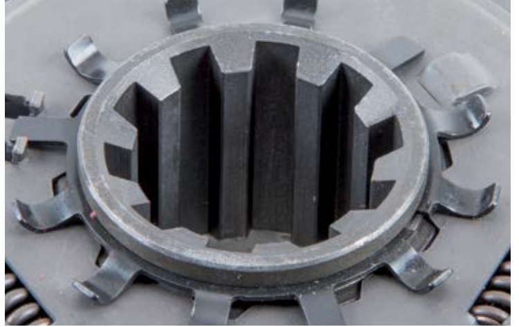
Resim 1: Nikel kaplamalı göbekler yağlanmamalıdır
