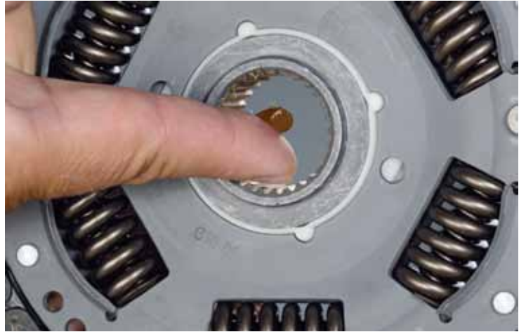
Şekil 1: Göbek frezelerini yağlama
