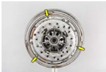
Resim 9: Kalan 3 vidayı elinizle vidalayın ve 10.5±1 Nm ile sıkılaştırın.
