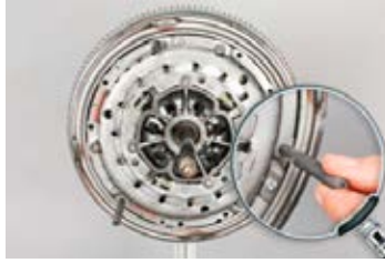
Resim 5: SAC aletindeki saplamaları hafif bir direnmeyle karşılaşıncaya kadar elinizle döndürün; herhangi bir alet kullanmayın.
