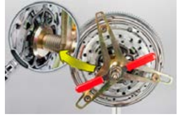
Resim 6: SAC aletini birleştirin ve kapak kenarı LuK DMF'de durana kadar öngerilme uygulayın.
