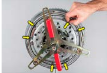
Resim 7: Tedarik edilen vidaları mevcut 6 vida dişine elinizle yerleştirin ve sonra 10.5±1 Nm ile sıkılaştırın.
