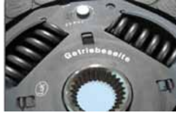
Şekiller 1 - 4: Debriyaj balatası üzerinde görülebilmesi muhtemel işaretlemeler
