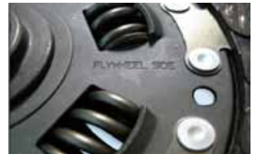
Şekiller 1 - 4: Debriyaj balatası üzerinde görülebilmesi muhtemel işaretlemeler
