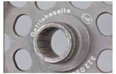
Şekil 2: Hasarlı frezeli göbek profili aşınması
