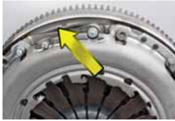
Şekil 1: Uzun civata kullanılması nedeniyle aşınmış malzeme
