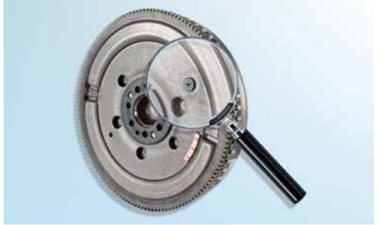
Şekil 1: DMF'de taşıma emniyet pimi motor ilk çalıştırıldığında iki parçaya ayrılır.
