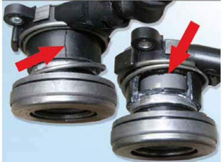
Şekil 5: CSC yanlış montaj sonucu zarar görür
