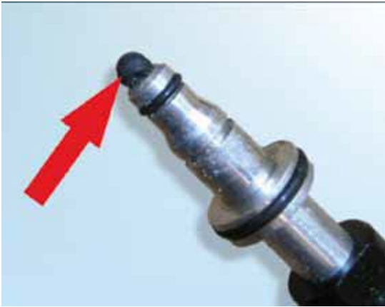
Şekil 4: Eğer eski conta çıkarılmadıysa CSC'nin içinde sıkışabilir ve tüpü tıkayabilir.
