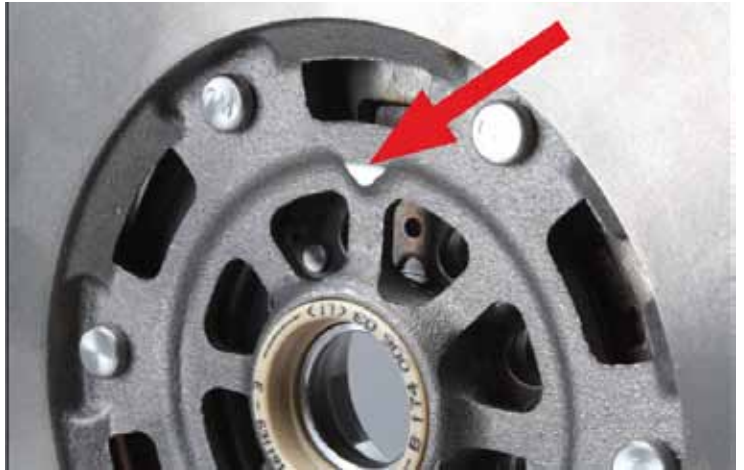
Şekil 3: Volanın şanzımana bakan tarafındaki üçgen işareti
