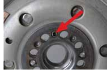
Şekil 2: Çift Kütleli Volan merkezleme deliği (krank tarafı)
