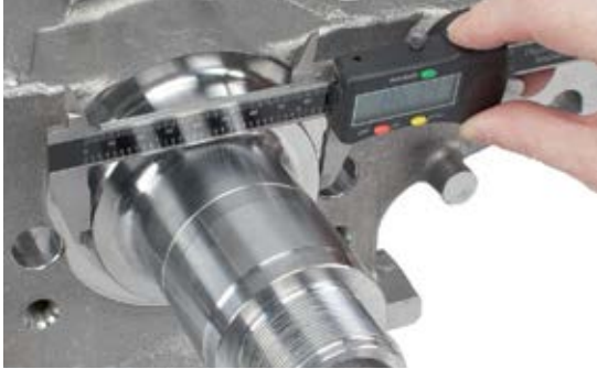
Resim 2: Üç koruyucu halkadan hangisinin takılması gerektiğini belirlemek için, dingil saplamasının tabanı ölçülmelidir.
